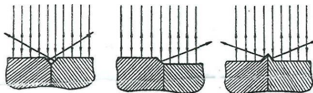
Рис. 5.1. Схема образования изображения рельефных границ зерен
