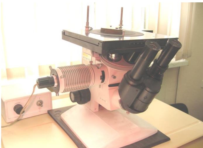
Рис. 5.3. Общий вид микроскопа METAM PB
