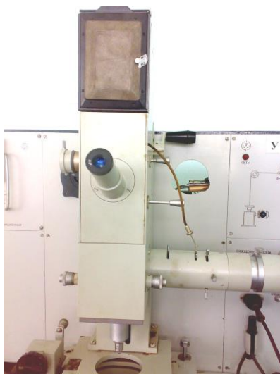
Рис. 7.3. Металлографический микроскоп типа МВТ
