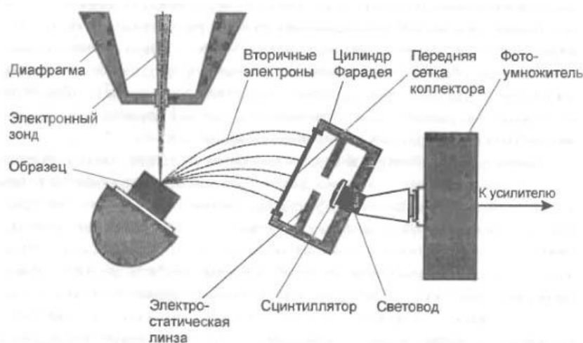
Схема детектора вторичных электронов
