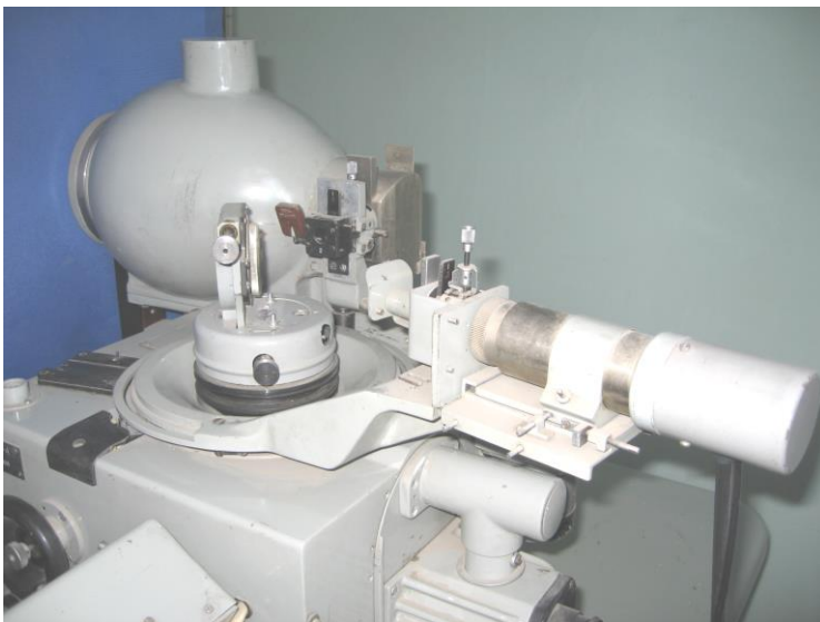
Рис. 9.2. Внешний вид и основные части рентгеновской установки
