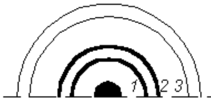
Рис. 14.4. Электронограмма кристаллического вещества. Индексы Миллера: 1 – (111); 2 – (200); 3 – (220)
