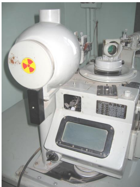
Рис. 9.6. Гониометрическая приставка дифрактометра
