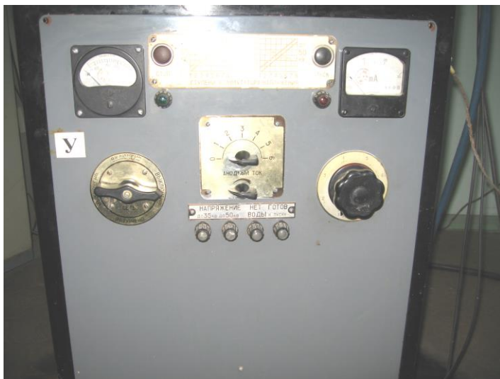
Рис. 9.7. Панель управления дифрактометра
