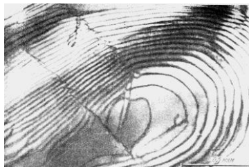
Рис. 8.3. Дислокационная структура низкоуглеродистой стали после холодной пластической деформации
