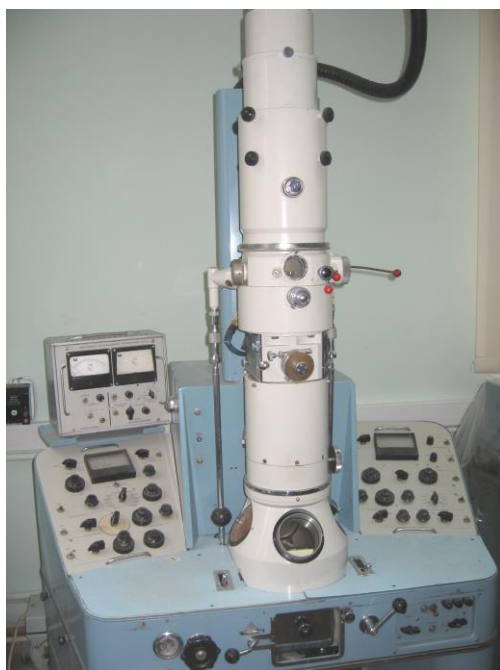
Рис. 8.1. Внешний вид просвечивающего электронного микроскопа
