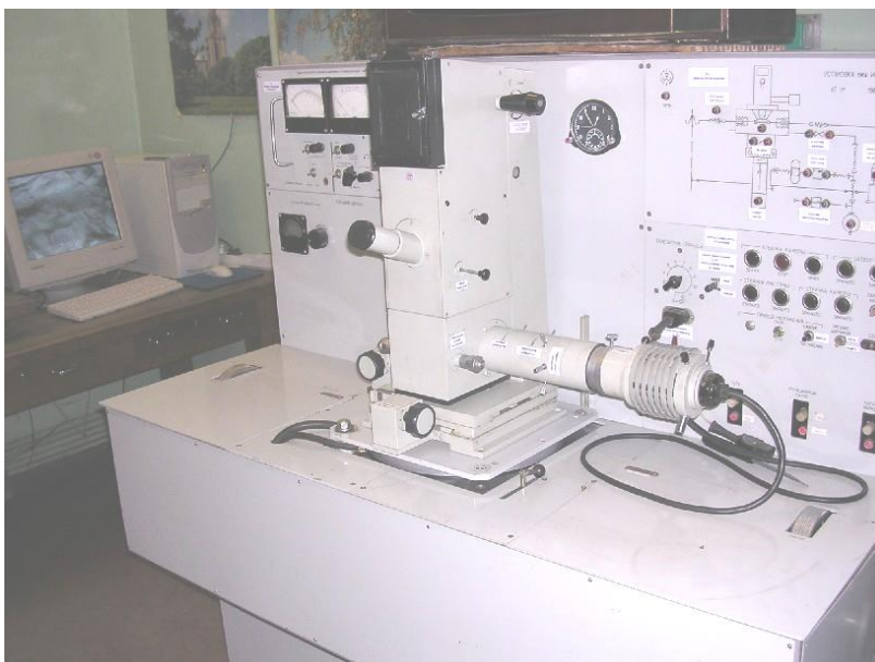
Рис. 7.1. Установка ИМАШ-20-75
