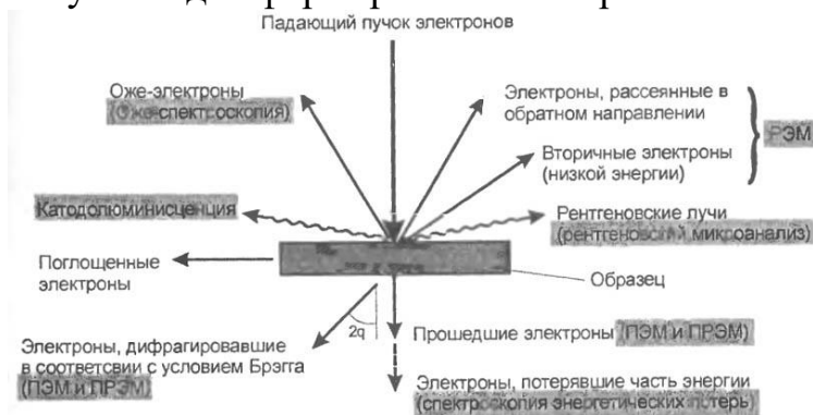
Типы излучений, возникающих в облучаемом электронами образце
