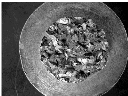
Рис. 2.3. Камневидный квазихрупкий излом
